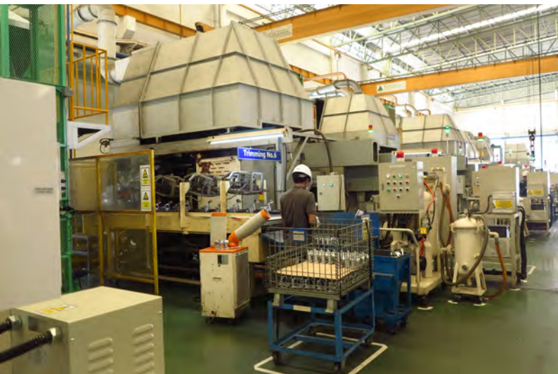
กระบวนการหล่อขึ้นรูปเรือนปีกผีเสื้ออิเล็กทรอนิกส์ (ETB)
