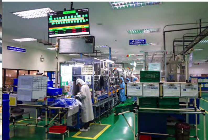
กระบวนการประกอบเรือนปีกผีเสื้ออิเล็กทรอนิกส์ (ETB)
