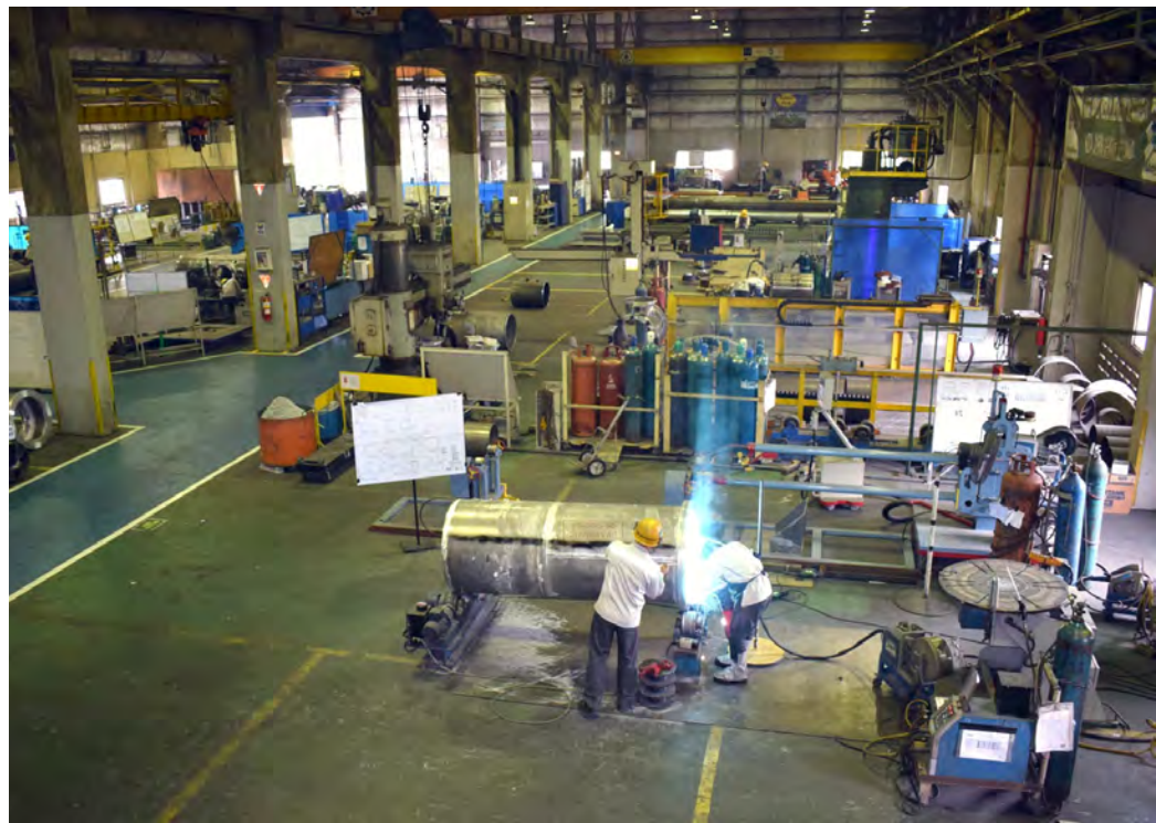
ส่วนของโรงงานผลิตที่ผลิตฝากรอบสวิตช์เกียร์ใช้น้ำมันก๊าซ ที่เรียกว่า ถังของสวิตช์เกียร์ใช้น้ำมันก๊าซ และตัวนำไฟฟ้า
