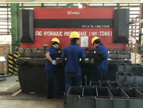
การผลิตถังหม้อแปลงไฟฟ้าด้วยเครื่องตัดพลาสมา CNC และใบมีดพับ CNC
