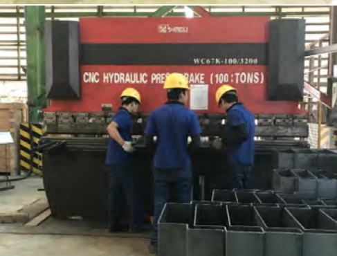
Produksi bodi Tangki Trafo oleh Mesin Pemotong Plasma CNC & Rem Tekanan CNC
