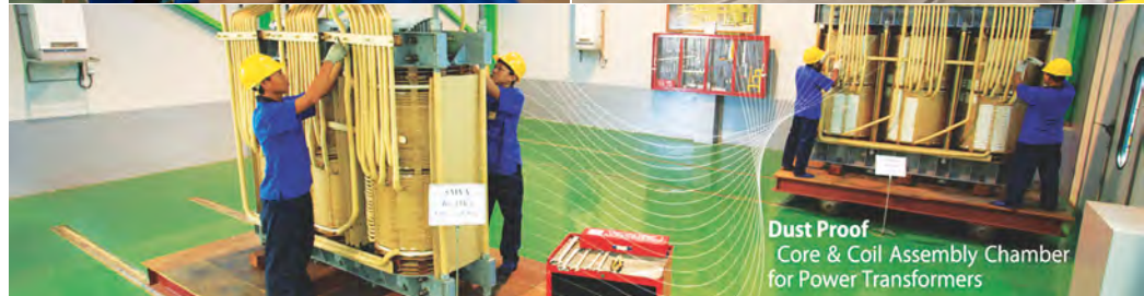
Perakitan inti dan kumparan di berbagai tahap trafo
