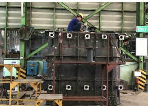
Bodi Tangki Trafo Daya
